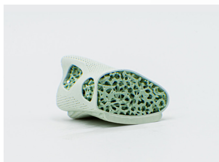
通过将两种陶瓷结合为一层而实现的骨置换假体
