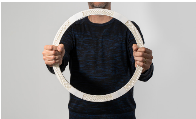
由 Alumina Systems 使用 LCM 技术打印的直径为 15 英寸的 ALD 环
